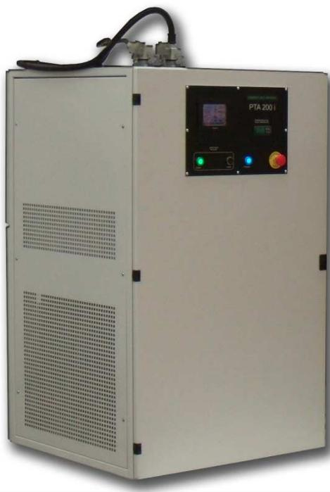
La saldatrice impiega il procedimento *Plasma ad Arco Trasferito* per eseguire saldature di giunzione e rivestimenti antiusura o anticorrosione con superleghe metalliche in polvere.
