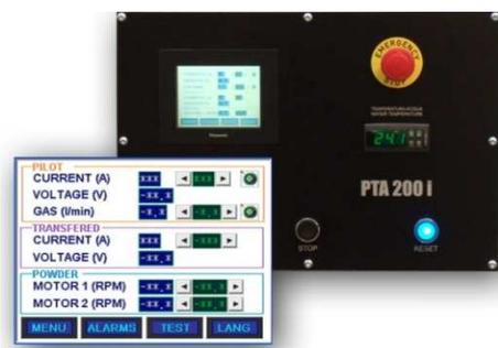
Il **quadro comandi** è costituito da un PLC grafico con schermo tattile con funzioni di **programmazione e monitoraggio dei parametri di saldatura**.
